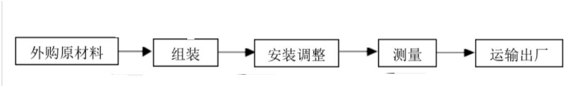
图 3-7 幕墙生产工艺流程
